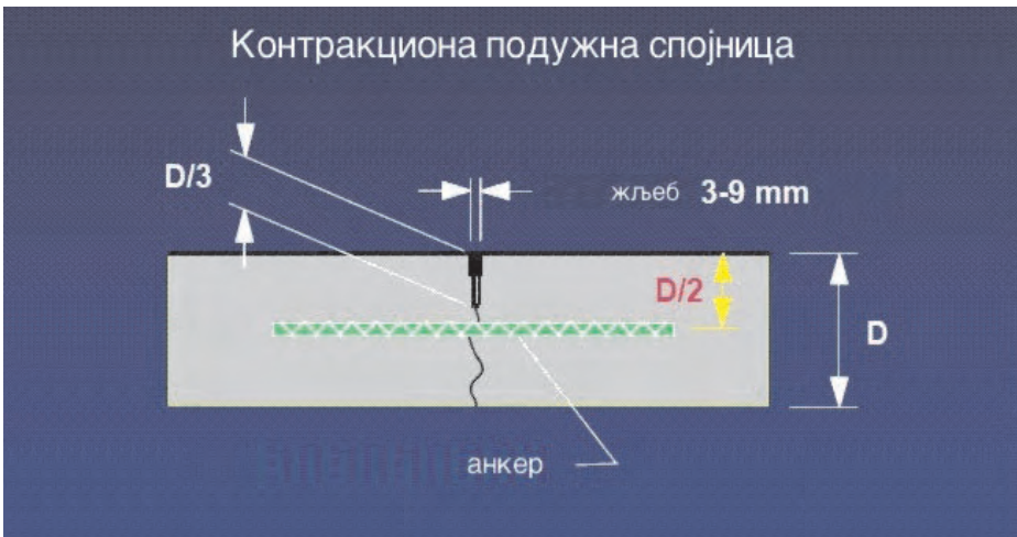
Слика 4.28 Контракциона подужна спојница
