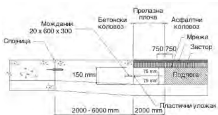
Слика 4.52 Веза бетонског и асфалтног коловоза
