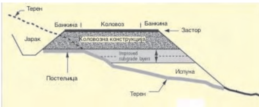
Слика 4.1 Положај коловозне конструкције у попречном профилу пута
