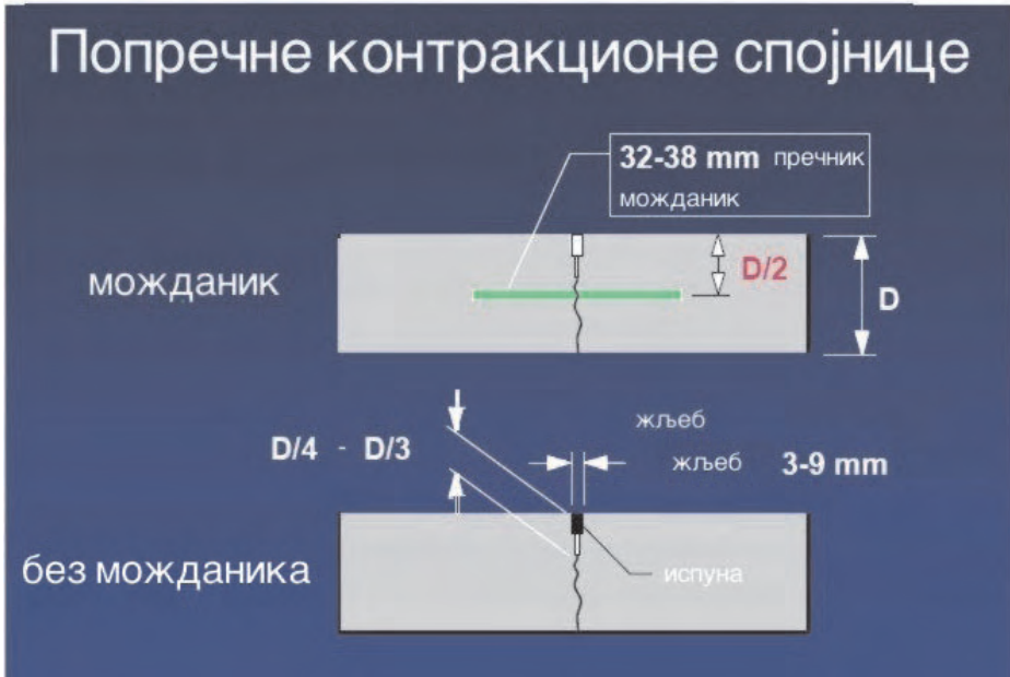
Слика 4.27 Попречна контракциона спојница
