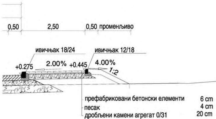
Слика 1.7. Детаљ тротоара на ниском насипу
