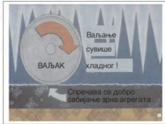
Слика 4.20 Ваљање недовољно топле масе даје лоше резултате
