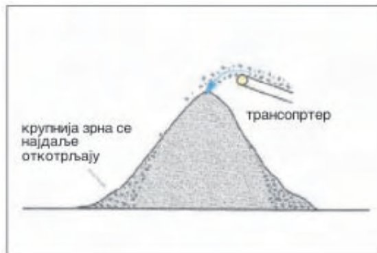
Слика 4.9 Приликом прављења депоније невезаних материјала обавезно долази до сегрегације агрегата
