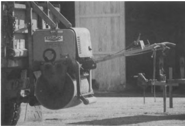
Слика 7.37 Полу-стални поступак (мали вибрациони ваљак)
