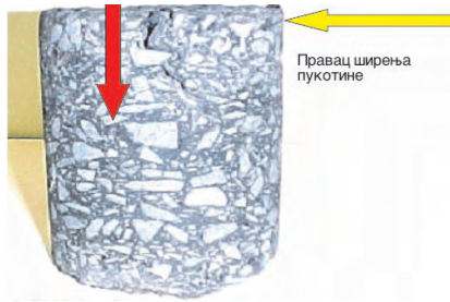
Слика 7.12 Настајање и правац ширења пукотине настале због дејства фактора средине
