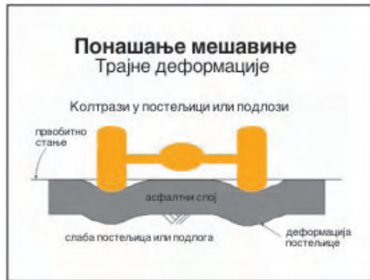
Слика 4.23 Колотрази могу бити последица лоше збијености, али и недовољне носивости коловозне конструкције
