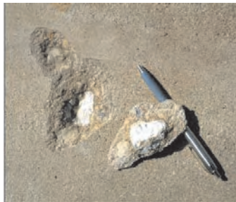
Слика 3.32 Последнице прљавог агрегата
