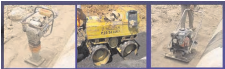
Слика 4.8 Ударна и вибрациона средства за набијање невезаних материјала
