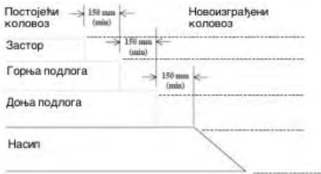
Слика 4.50 Обрада крајева слојева коловозне конструкције
