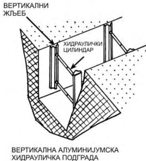
Слика 6.27. Хидраулички подградни систем
