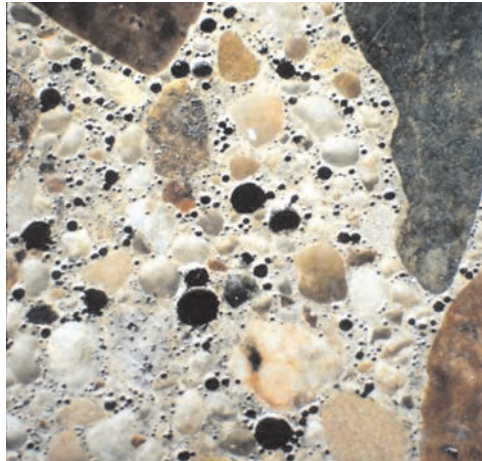
Слика 3.28 Шупљине испуњене ваздухом (дејство аераната)
