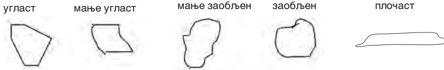
Слика 3.2 Облици агрегата
