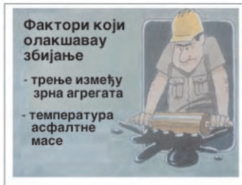
Слика 4.16 Фактори који олакшавају збијање
