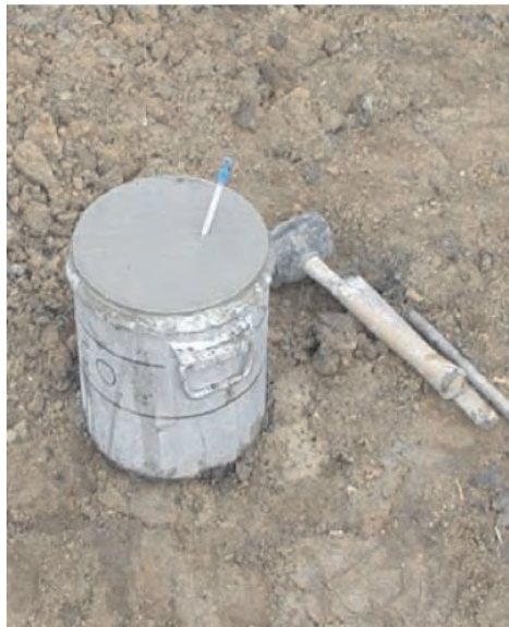
Слика 4.31 Контрола температуре бетона (не испод 4 °С)
