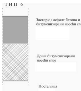
Слика 4.6 – Савремене типске коловозне конструкције - ТИП 6
