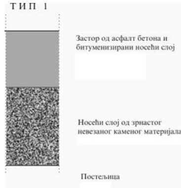
Слика 4.1 – Савремене типске коловозне конструкције - ТИП 1
