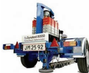
Слика 5.2 – FWD (Falling Weight Deflectometer) уређај за мерење угиба са падајућим теретом
