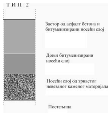
Слика 4.2 – Савремене типске коловозне конструкције - ТИП 2
