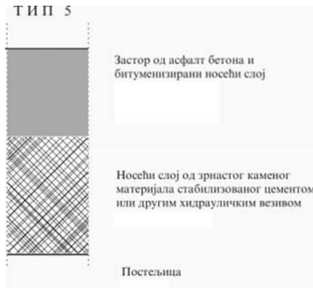
Слика 4.5 – Савремене типске коловозне конструкције - ТИП 5
